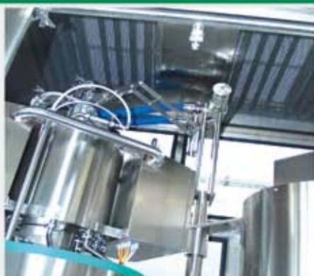
Рассеиватели для подачи ламинарного стерильного воздуха с HEPA фильтрами, асептический клапан подачи продукта, мойка чистой камеры с контролируемым потоком сверху вниз
